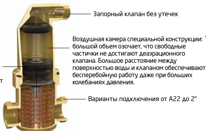
Exvoid "Латунь" - пример монтажа
