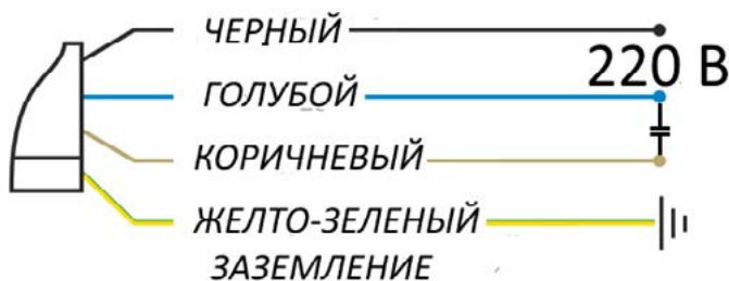
Рис.4 Подключение однофазного электродвигателя с выносным конденсатором
