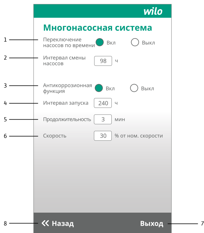
Рис. 5.1.12. Настройка системы из нескольких насосов
