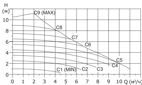
**Рис. 38** В зависимости от типоразмера насосного агрегата доступны от одной до девяти фиксированных частот вращения
