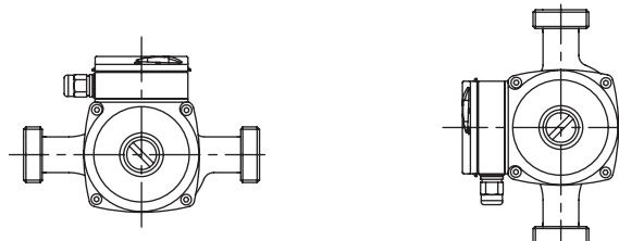
Рис. 8 Возможная ориентация вала
