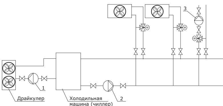
1. Насос контура конденсатора и драйкулера;
