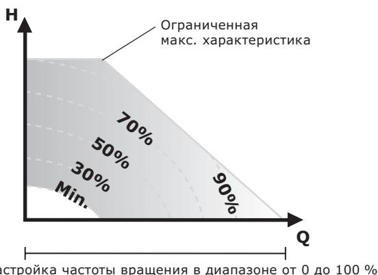
**Рис. 54** Ограничения по мощности и давлению, влияющие на максимальную характеристику
