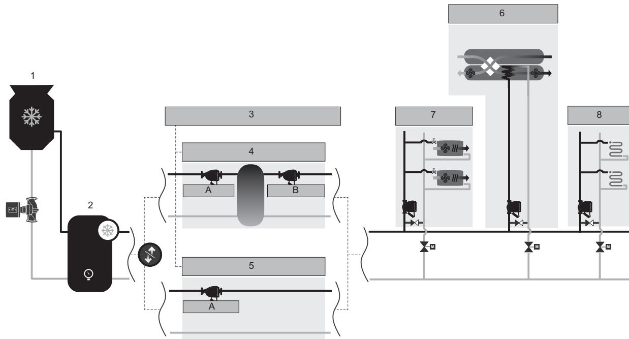
**Рис. 42** Функциональная схема системы охлаждения в коммерческом здании
