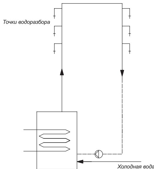
**Рис. 11** Одноконтурная схема контура рециркуляции горячей воды
