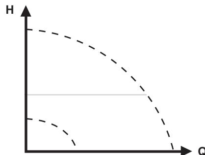
**Рис. 47** Регулирование по постоянному давлению
