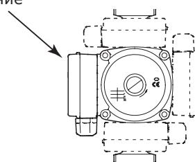
Рис. 9 Возможное положение блока управления для системы отопления
