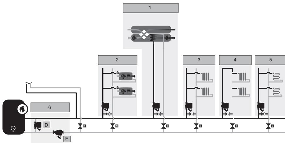
**Рис. 41** Функциональная схема системы отопления в коммерческом здании
