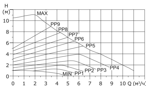
**Рис. 36** В зависимости от типоразмера насосного агрегата доступны от одной до девяти кривых режима управления пропорционального давления.
