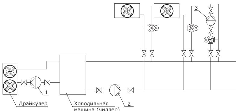
**Рис. 15** Схема системы охлаждения и кондиционирования воздуха
